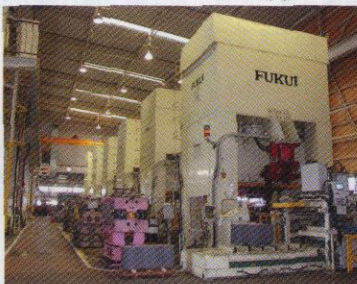
ハンドリングロボット付 大型タンデムプレスライン (滋賀)
