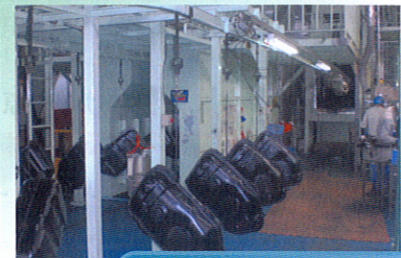
フューエルタンクライン
